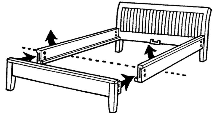
**2.** So verbinden Sie dann die Fußwange mit den Seitenwangen: Beide Seitenwangen gleichzeitig anheben und genau wie beim Betthaupt mit der Fußwange verbinden.
