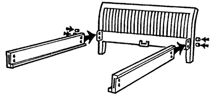
**1.** Stellen Sie das Betthaupt auf und stecken Sie die beiden Seitenwangen in die Laschen des Betthauptes ein – mit den Auflageleisten für den Lattenrost nach innen. Heben Sie die Seitenwangen etwas an, sodass Sie die Verbindungsstifte leicht einstecken können.
